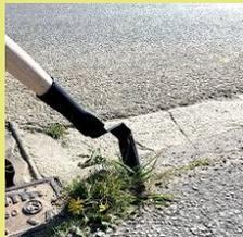
A pic-bine tool with a long handle and a circular head, used for weed control on paved surfaces. | <p><b>Avantages</b></p> <ul style="list-style-type: none"><li>- Maniable d'utilisation.</li><li>- Coût réduit.</li><li>- Précision.</li></ul> <p><b>Inconvénients</b></p> <ul style="list-style-type: none"><li>- Temps de travail important.</li><li>- Travail souvent physique.</li></ul>                                                                                                           |
