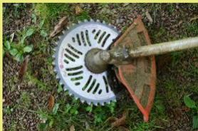
A reciprocating tool with a circular head and a long handle, used for weed control on gravel surfaces.    | <p><b>Avantages</b></p> <ul style="list-style-type: none"><li>- Investissement modéré.</li><li>- Maniable et simplicité d'utilisation.</li><li>- Peu de projection.</li></ul> <p><b>Inconvénients</b></p> <ul style="list-style-type: none"><li>- Nombre de passage important.</li><li>- Consommation d'énergie fossile.</li></ul>                                                                    |
