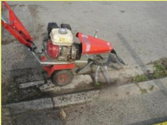
A red and white rotating brush machine used for weed control on paved surfaces.                          | <p><b>Avantages</b></p> <ul style="list-style-type: none"><li>- Simple d'utilisation.</li><li>- Bonne efficacité sur pavés.</li><li>- Coût d'investissement modéré.</li><li>- Retrait des fines.</li></ul> <p><b>Inconvénients</b></p> <ul style="list-style-type: none"><li>- Possible dégradation des joints.</li><li>- Usure des brosses.</li><li>- Nombre de passages élevé.</li></ul>            |
